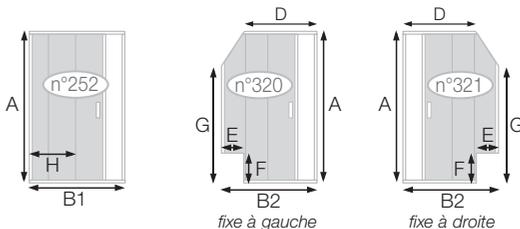
**SMART DESIGN FIXE (p.179)** **INFO :** Paroi fixe pour montage en angle avec les portes Smart Design (avec seuil)
