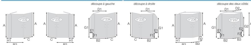
Dans les deux cas ci-dessus, l'une des largeurs B2 ou B3 devra être obligatoirement comprise entre 1001 et 1190 mm
