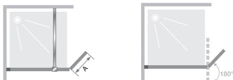
Voilet pivotant installé avec la paroi Smart Design Solo
